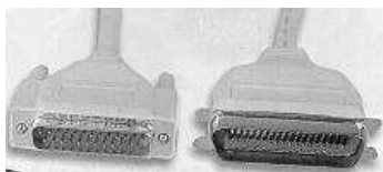
Figura 2: Cavo per stampante parallela
