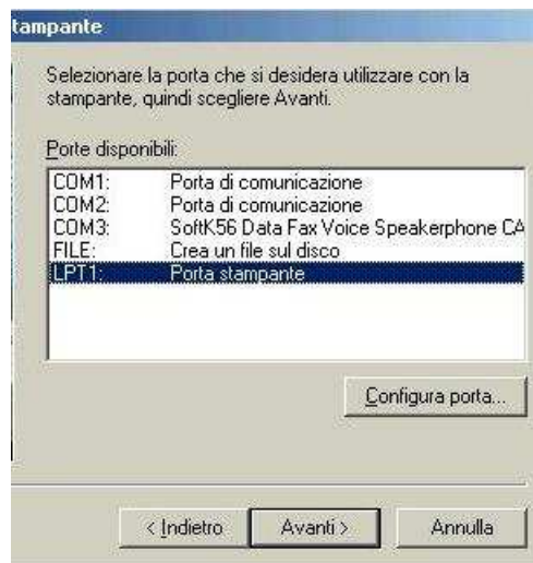
Figura 10: Scelta della porta di comunicazione tra PC e stampante. Nel nostro caso LPT1
